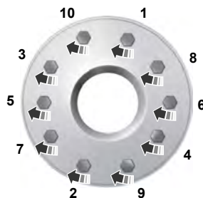
10-lug nut torque sequence
