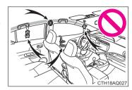
Véhicules sans système d'accès et de démarrage mains libres: Ne fixez pas d'objets lourds, pointus ou très durs, tels que des clés et des accessoires aux clés. Ces obiets risquent d'entraver le déploiement du coussin gonflable de genoux du conducteur SRS ou d'être projetés vers le siège conducteur par la force de déploiement du coussin gonflable, constituant ainsi un danger potentiel.
