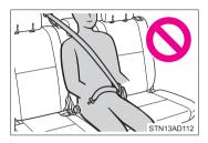
Ne pas utiliser la ceinture de sécurité du siège central de troisième rangée sans deux boucles aue ses ne soient attachées. Fixer une seule boucle pourrait occasionner des blessures graves, voire mortelles, en cas de freinage brusque ou de collision.
